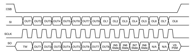
Figure 22. SPI Frame
