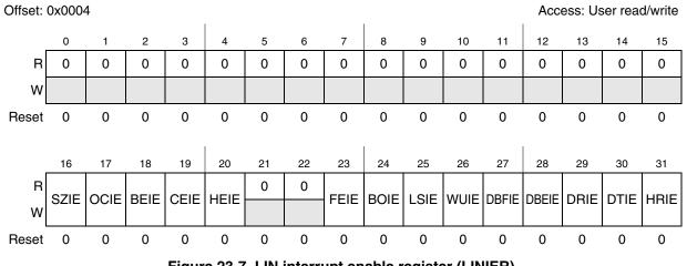
Figure 23-7. LIN interrupt enable register (LINIER)
