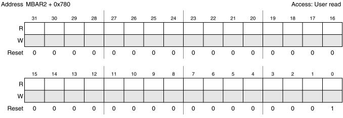
Figure 24-24. Configure Flag (CONFIGFLAG) Register
