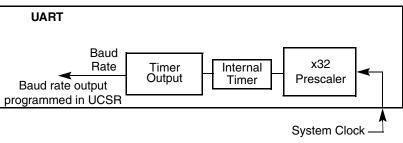
Figure 15-3. Baud-Rate Timer Generator Diagram
